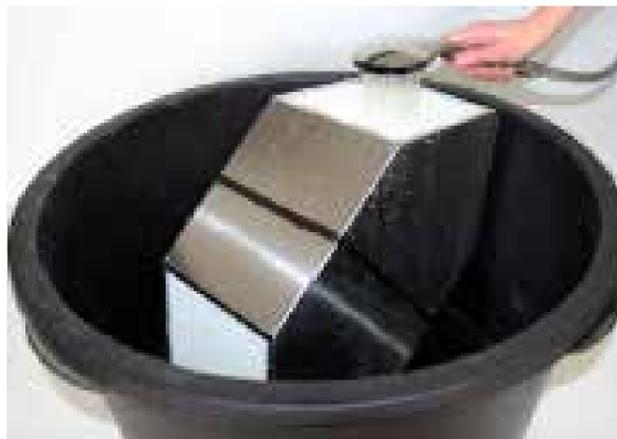
3. Geben Sie etwas Wasser mit einem milden Spülmittel versetzt in die Wanne und schöpfen Sie die Seifenlösung mit einem geeigneten Gefäß (z. B. Becher) aus der Wanne und lassen Sie die Lösung in jede Öffnung des Tauschers laufen (alle offenen Seiten).
