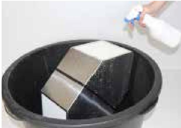
5. Leeren Sie die Wanne und stellen Sie sicher, dass sich keine Rückstände des Desinfektionsmittels mehr darin befinden. Stellen Sie den Tauscher wieder in die Wanne und spülen Sie ihn gründlich mit klarem Wasser aus.
