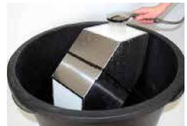
3. Besprühen Sie jede Öffnung des Tauschers (alle offenen Seiten) großzügig mit der Peressigsäure, um eine vollständige Benetzung der Membran sicherzustellen. Lassen Sie anschließend das Mittel kurz einwirken.
