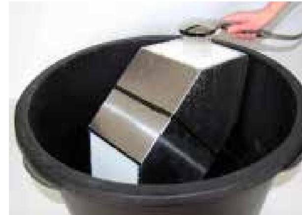
8. Entfernen Sie im Tauscher verbliebenes Wasser durch mehrmaliges Drehen und trocknen Sie den Tauscher mit einem Trockentuch.
