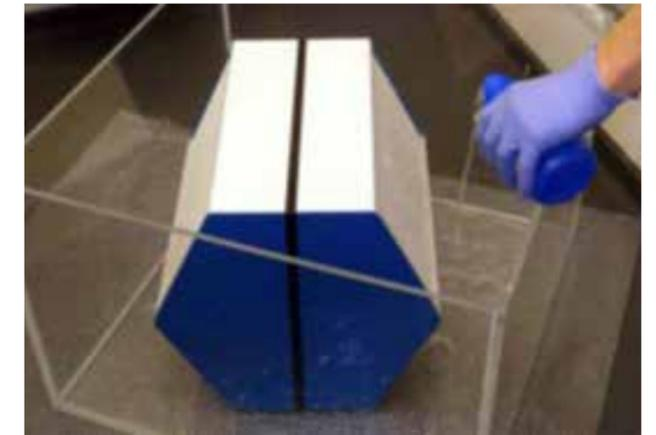
4. Schöpfen Sie die Lösung mit einem geeigneten Gefäß (z. B. Becher) aus der Wanne und lassen Sie die Lösung in jede Öffnung des Tauschers laufen (alle offenen Seiten). Wiederholen Sie diesen Vorgang zwei Mal, so dass eine vollständige Benetzung der Membran bzw. der Kanäle sichergestellt ist.
