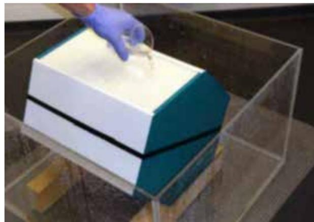
7. Leeren Sie die Wanne und stellen Sie sicher, dass sich keine Natrium-hypochlorit-Lösung mehr darin befindet. Legen Sie zwei Klötze in die saubere Wanne. Dies ist später hilfreich für den Ablauf des Wassers aus dem Tauscher.
