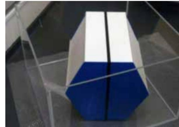
2. Spülen Sie zur Reinigung den Tauscher vor der Desinfektion von allen Seiten mit Wasser.
