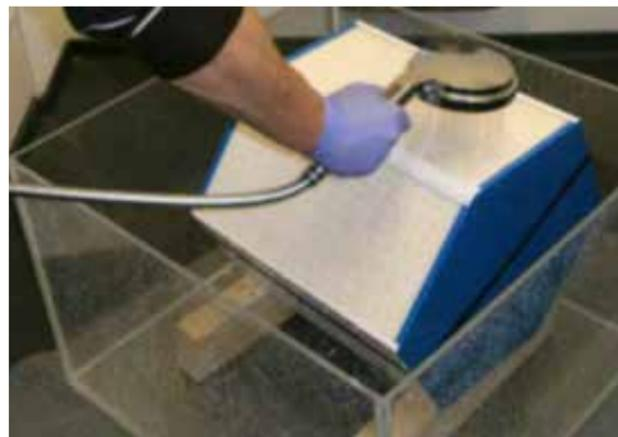
11. Entfernen Sie im Tauscher verbliebenes Wasser durch mehrmaliges Drehen und trocknen Sie den Tauscher mit einem Trockentuch.
