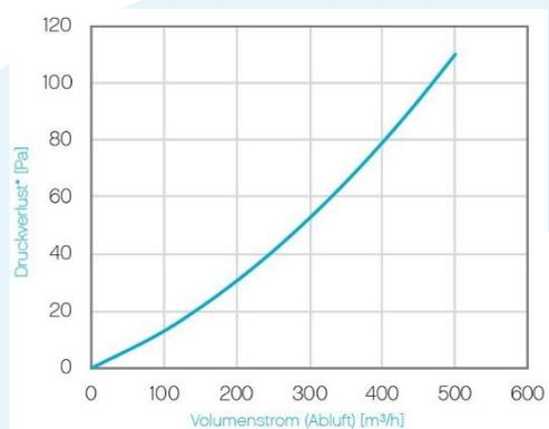
\*Basierend auf WT-Höhe 500 mm, Testbedingungen in Anlehnung an DIN EN 308:1997-06 (Außenluft: Temp.: 5 °C, Luftfeuchte: 70 %; Abluft: Temp. 25 °C, Luftfeuchte. 50 %).
