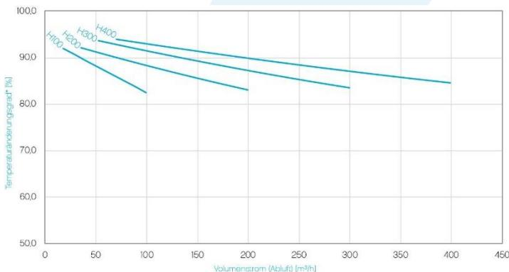
\*Testbedingungen in Anlehnung an DIN EN 308:1997-06 (Temp. Außenluft: 5 °C, Luftfeuchte 70 %; Temp. Abluft: 25 °C, Luftfeuchte 50 %).
