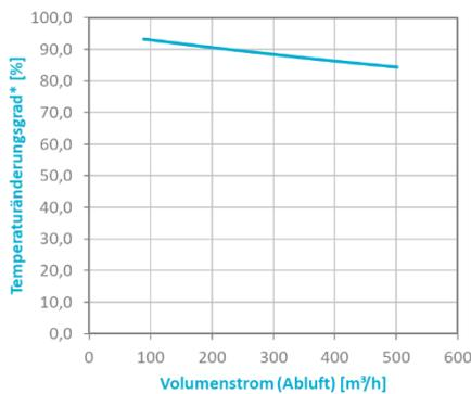
\*Basierend auf WT-Höhe 500 mm, Testbedingungen in Anlehnung an DIN EN 308:1997-06 (Außenluft: Temp.: 5 °C, Luftfeuchte: 70 %; Abluft: Temp. 25 °C, Luftfeuchte. 50 %).
