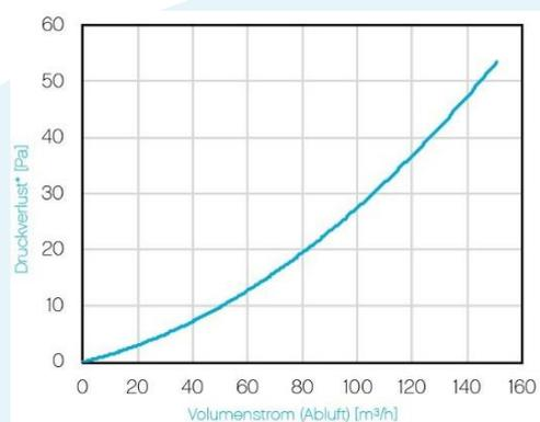
\*Basierend auf WT-Höhe 300 mm, Testbedingungen in Anlehnung an DIN EN 308:1997-06 (Außenluft: Temp.: 5 °C, Luftfeuchte: 70 %; Abluft: Temp. 25 °C, Luftfeuchte. 50 %).
