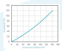
\*Basierend auf WT-Höhe 300 mm, Testbedingungen in Anlehnung an DIN EN 308:1997-06 (Außenluft: Temp.: 5 °C, Luftfeuchte: 70 %; Abluft: Temp. 25 °C, Luftfeuchte. 50 %).
