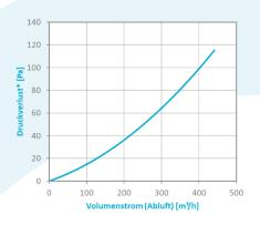
\*Basierend auf WT-Höhe 500 mm, Testbedingungen in Anlehnung an DIN EN 308:1997-06 (Außenluft: Temp.: 5 °C, Luftfeuchte: 70 %; Abluft: Temp. 25 °C, Luftfeuchte. 50 %).
